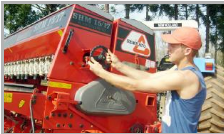
PRODUTOR Tiago fazendo o ajuste detalhado na regulagem do número de sementes a serem plantadas.
