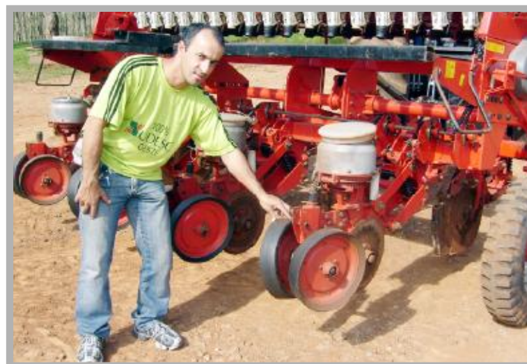
PROFESSOR Edir mostrando a roda que faz o controle de profundidade de sementeira
